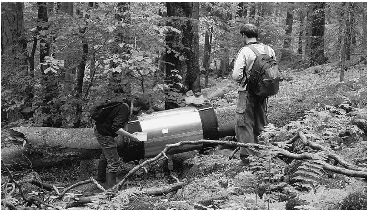
Abb. 1: Eklektoren an liegenden Baumstämmen sind Kombinationsfallen, die getrennt die Tiere fangen, die aus einem einen Meter langen Stammabschnitt schlüpfen bzw. die, die auf Stämmen entlang laufen oder an ihnen entlang fliegen (Foto: Jens-Peter Kopelke).
