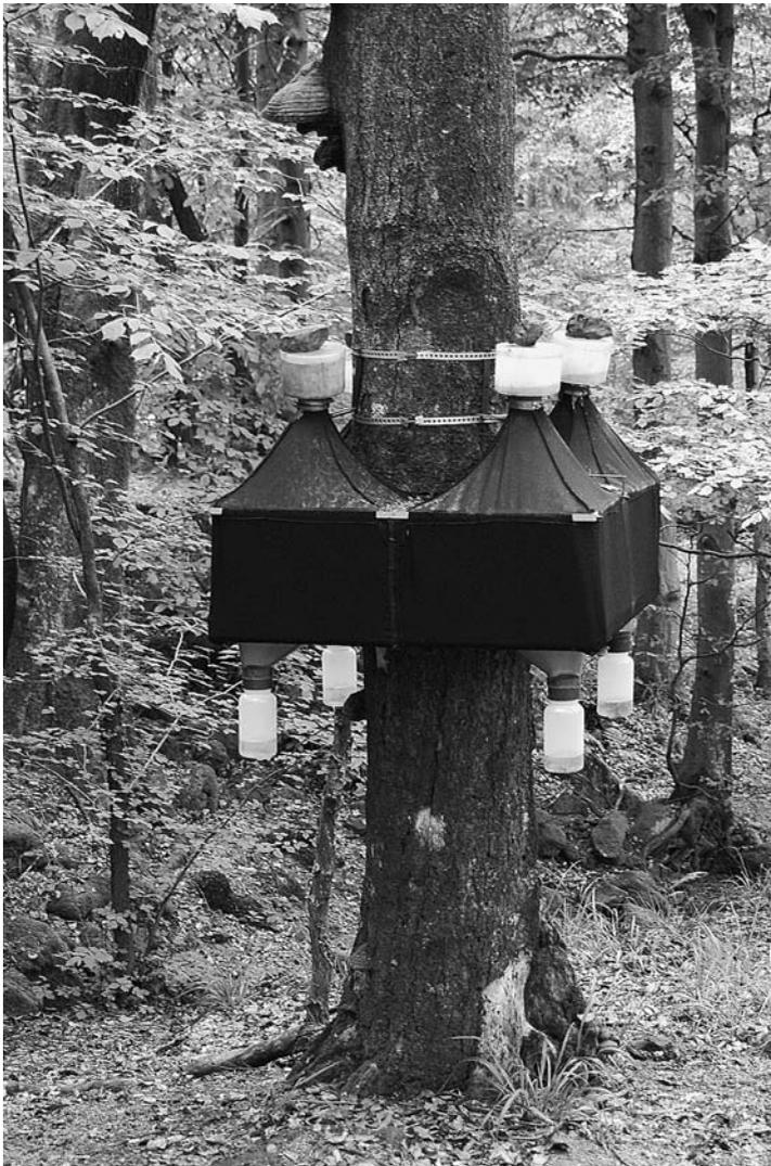
Abb. 2: Eklektoren an Dürrständern fangen am Stamm emporlaufende oder -fliegende Tiere (Foto: Jens-Peter Kopelke).
